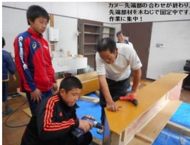
カヌー先端部の合わせが終わり、先端部材を木ねじで固定中です。作業に集中！
