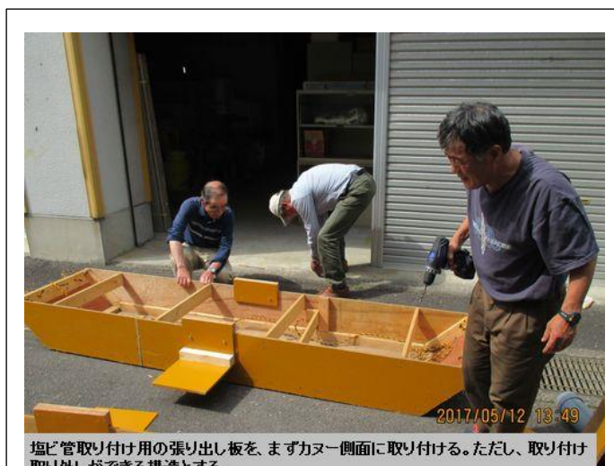
カヌーの揺れ防止用塩ビ管を取り付けるための張り出し板を加工中。
