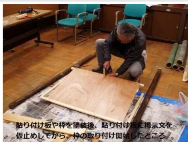
貼り付け板や枠を塗装後、貼り付け板に掲示文を仮止めしてから、枠の取り付け開始したところ
