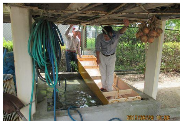
進水式ならぬ水密性試験を交流会館の水槽を使わせていただき、全没できないので片側ずつ水没させて、漏れがないか確認した。交流会館に感謝！
